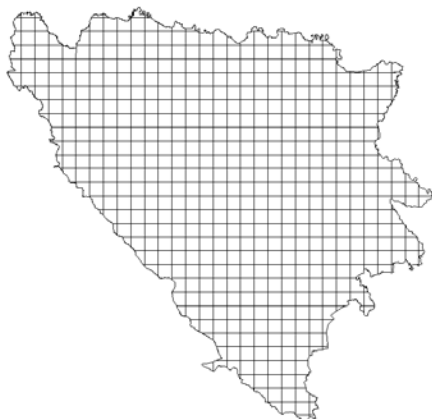
Sl. 5. Konstruisanje pravougule mrže za određivanje elementarne površine Fig. 5. Construction of the rectangular network in order of determination of the elemental surface
